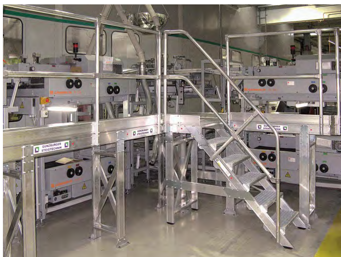
Aluminium vast opgestelde werkborde.
