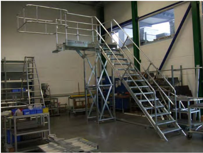
Aluminium vast opgestelde brugtrap, 2-zijdig begaanbaar (hoek constructie).
