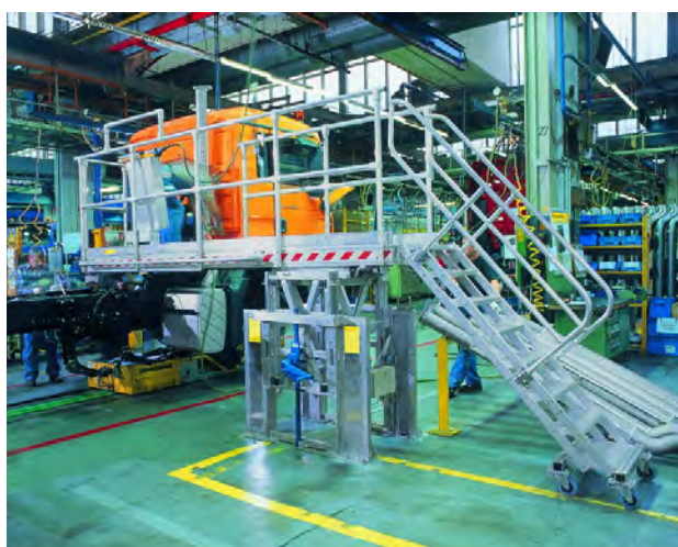
Aluminium zwenkbaar in hoogte verstelbaar werkstation met variotrap. Tevens is het platform uitschuifbaar.
