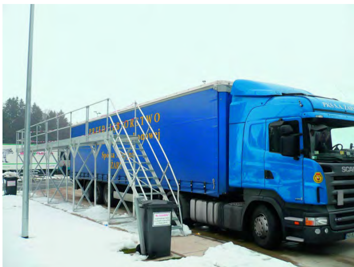
Aluminium verrijdbare werkstation, uitgevoerd met een vaste trap. Met 3 verdiepingen.
