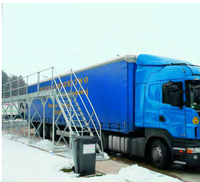
Koilladder uitgevoerd met staal verzinkte afsluitdeur en inloopbeveiliging
