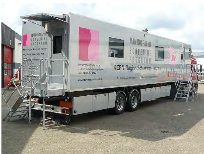
Aluminium overstapbordes met 1 zijde trapopgang & 1 zijde ladderopgang.
