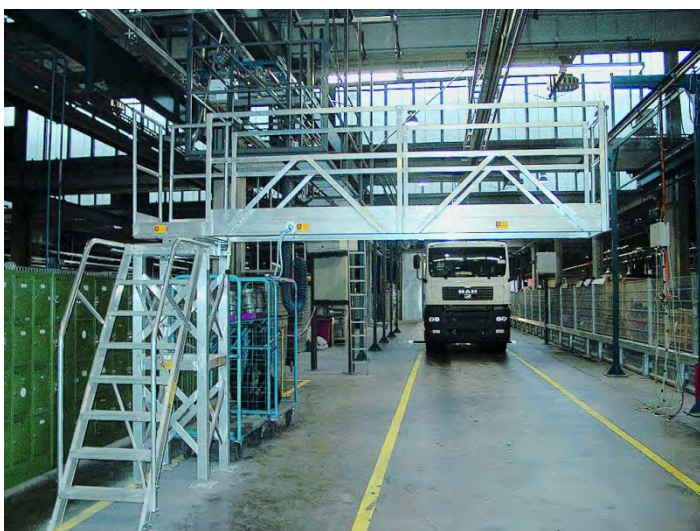
In hoogte verstelbare tankwagenladder uitgevoerd met spindels, platform en vierkante leuningring (desgewenst ronde korf ook leverbaar).
