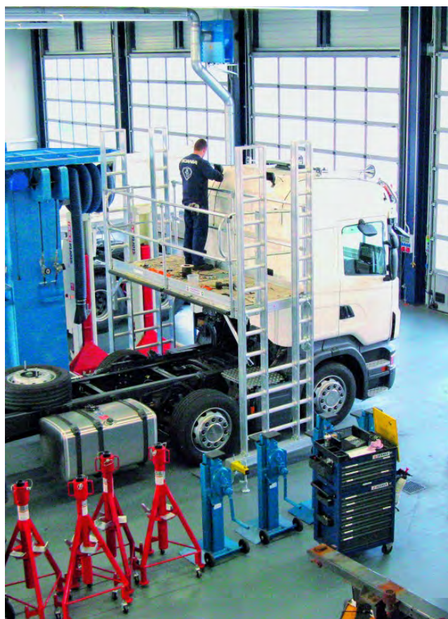
Aluminium verrijdbaar werkplatform met demontabel leuningwerk en ladderconstructie.
