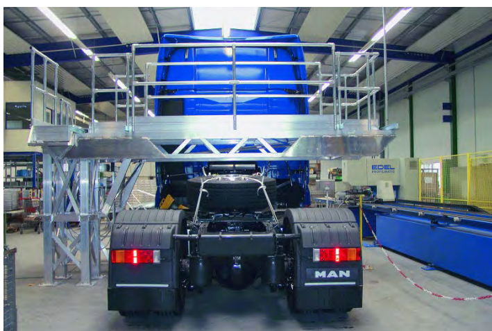
Aluminium platformtrappen met verschillende platformhoogtes. Uitgevoerd met aluminium ponsrooster.
