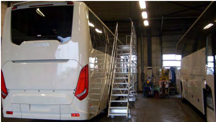
Aluminium vast opgestelde platformtrap.
