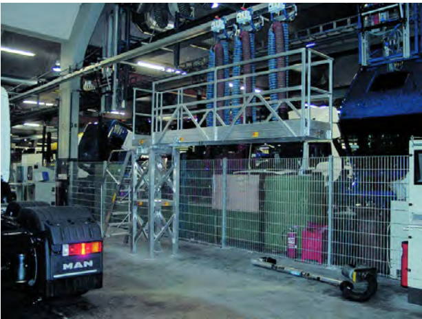
Aluminium vast opgesteld wegdraaibaar werkplatform met toegangstrap.
