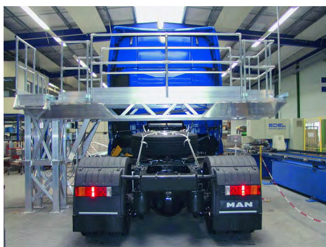
Aluminium vast opgesteld werkplatform, wegdraaibaar met diverse toegangsmogelijkheden.
