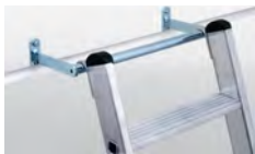
Ladder ophangconsole Wandafstand 160 mm, breedte 475mm, buis Ø 25mm. Staalverzinkt
