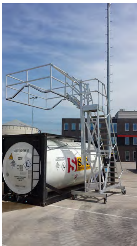
Tankwagenladder met in hoogte verstelbare kooi
