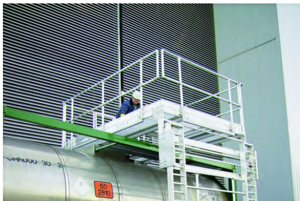
Aluminium verrijdbare onderhoudstrap met scharnierend leuningwerk en rubberen stootranden.
