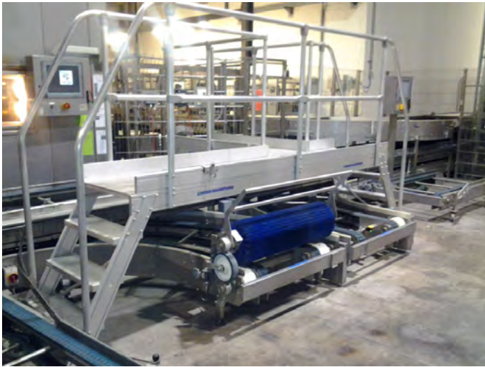
Aluminium vast opgestelde brugtrap met uitlooppplatform, 3-zijdig begaanbaar.
